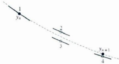
Figura 5.4 - O método Runge-Kutta de 4ª ordem. Em cada passo a derivada é calculada quatro vezes: uma no ponto inicial, duas nos pontos médios, e mais uma no ponto final. Destas derivações, o valor final da função (mostrado com um ponto cheio) é calculado para o ponto seguinte (figura retirada de Press et al. (1992)).
