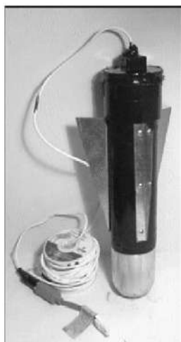
Figura 2-8 - Penetrômetro com cabo de sistema de aquisição (Spooner et al., 2004, segundo Alves e Danziger, 2008)
