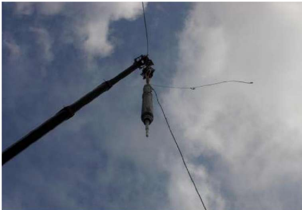
Figura 5-13 - Influência do vento nos lançamentos do piezocone-torpedo (Henriques Junior et al. 2010)
