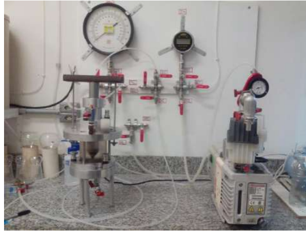
Figura 5-7 – Sistema de calibração empregado para os transdutores de poro-pressão , adaptado de Danziger et al., 2008
