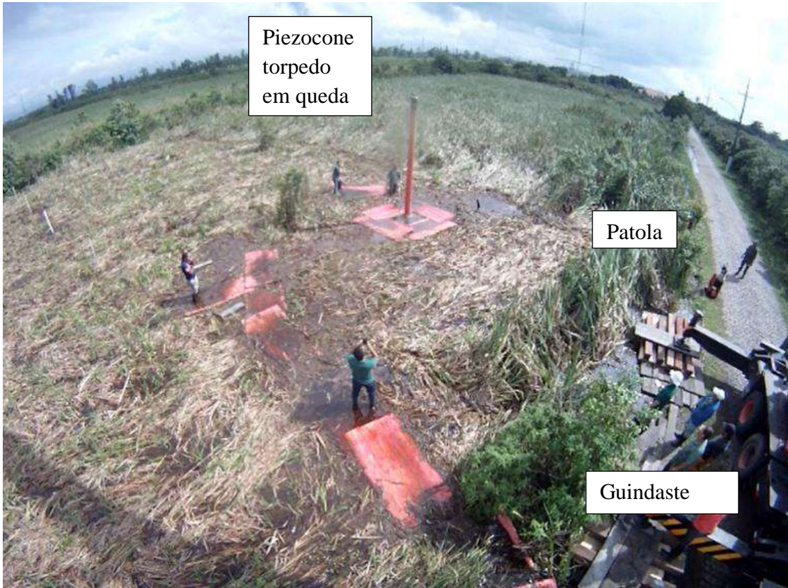
Figura 5-11 – Piezocone-torpedo durante queda livre, campanha de 2014. (Foto retirada de vídeo feito com GOPRO)
