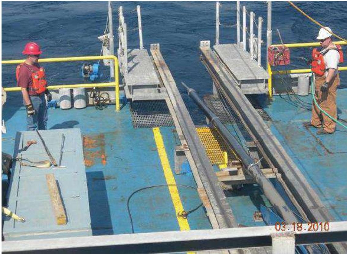
Figura 2-11 – Posicionamento do CPT stinger na popa da embarcação (Young et al., 2011)
