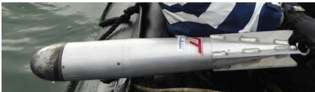
Figura 2-16 – Penetrômetro de queda livre portátil “Bluedrop” (Stark et al. 2016)
