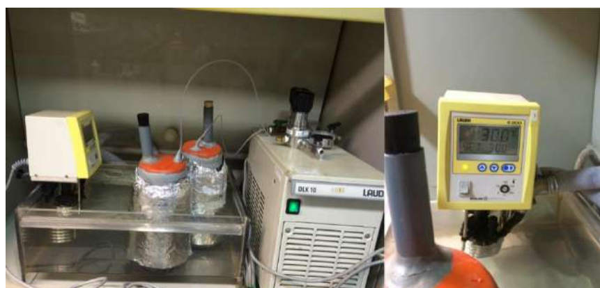
Figura 12: Biodigestores de 3 L dentro do banho automático (à esquerda) e temperatura controlada (à direita).
