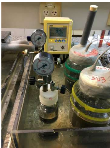
Figura 16: Biodigestores de 3 litros e 250 mL no banho LAUDA
