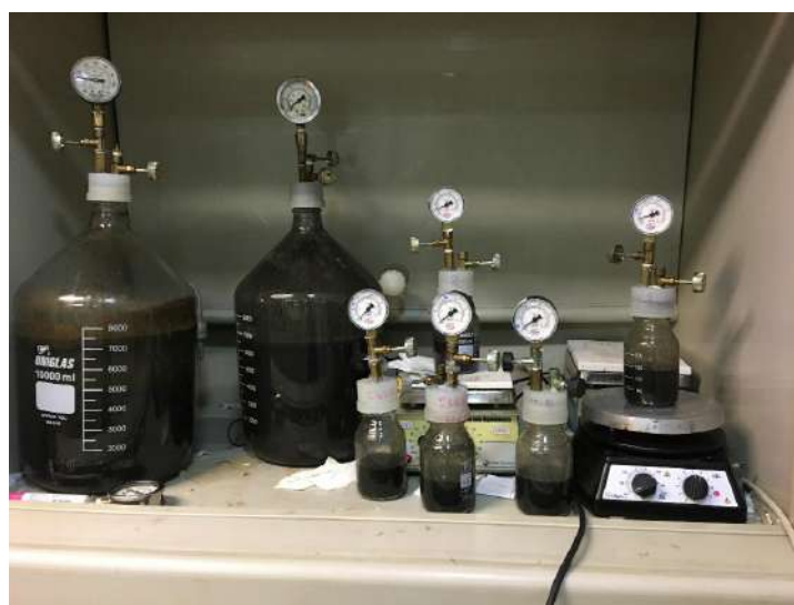
Figura 13: Biodigestores de 250 mL alimentados
