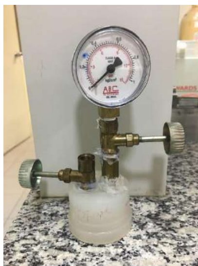
Figura 9: Tampa adaptado do biodigestor
