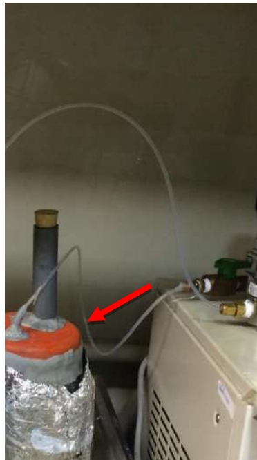
Figura 20: Cãnula saindo do biodigestor e indo diretamente ao manômetro, sem recipiente para coleta de umidade.
