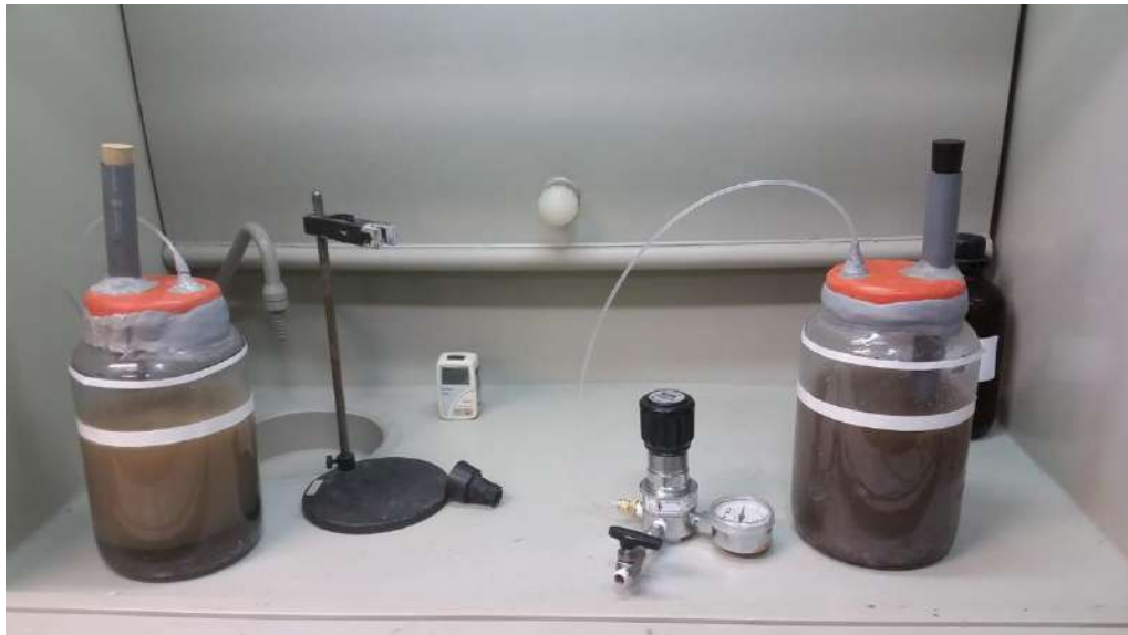
Figura 11: Biodigestores de 3L alimentados, à esquerda (meio diluente: água) e à direita (meio diluente: esgoto).
