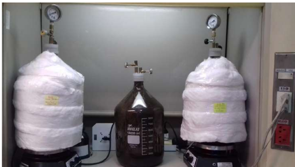
Figura 15: Biodigestores prontos nas placas de aquecimento e agitação
