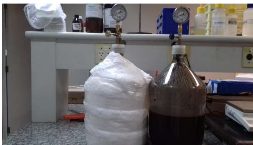
Figura 14: Biodigestores prontos com e sem a manta de fibra de vidro
