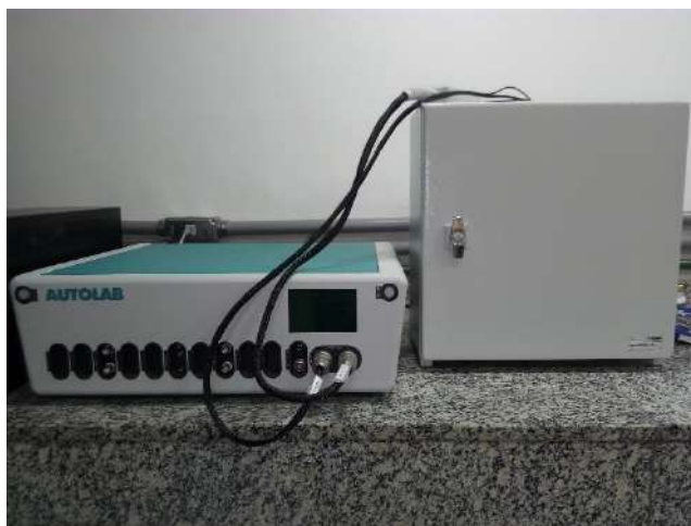
Figura 13 - Potenciostato/galvanostato Metrohm® AUTOLAB PGSTAT 302N, utilizado para análise de OCP e impedância eletroquímica.
