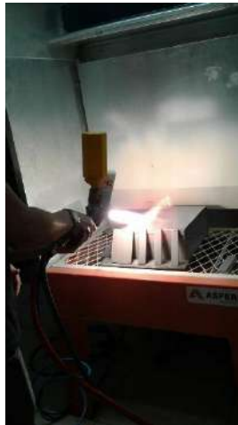
Figura 8 - Processo de aspersão térmica através de chama a pó.
