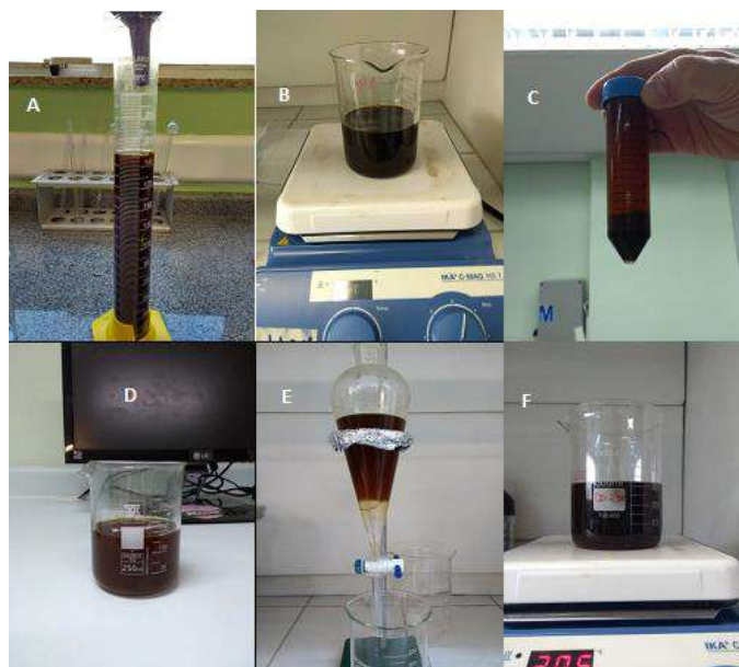
Figura 35: (A) Óleo de Nim, (B) Reação de esterificação, (C) Produto Centrifugado, (D) Secagem da fração apolar, (E) Lavagem (F) Fração apolar seca para transesterificação
