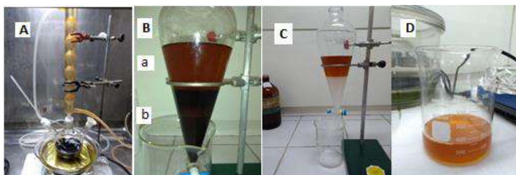
Figura 36: (A) Reação de transesterificação, (B) Produtos da reação: (a)- biodiesel e (b)- glicerina bruta, (C) Lavagem do biodiesel, (D) Secagem do biodiesel
