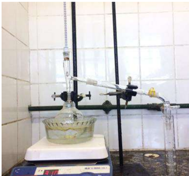
Figura 19. Sistema utilizado na síntese de \beta -cetoésteres.
