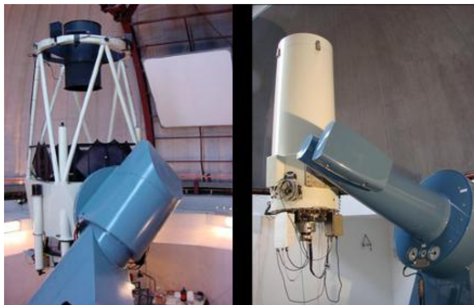
FIGURA 2.1. Telescópios do Observatório do Pico dos Dias (OPD), em Brazópolis - MG. À esquerda, vemos o telescópio de 1.6m (Pelkin-Elmers) e na direita, o telescópio de 0.6m (Boller-Chivens) (LNA, 2022).
