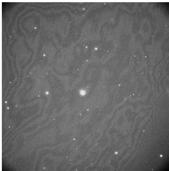
FIGURA 3.1. Exemplo de imagem sem calibração fotométrica com o aparecimento de vinhetes
