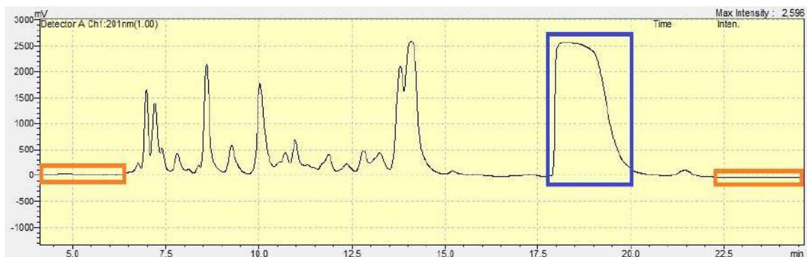
Figura 16: Cromatograma do CLAE, em azul o manool, e em laranja as áreas de reciclo de solvente
