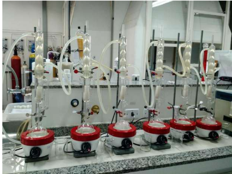
Figura 22. Sistema de extração Soxhlet para determinação dos extrativos. Fonte: Própria.
