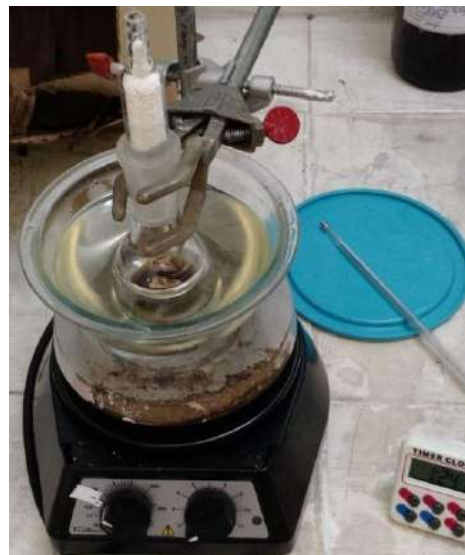
Figura 20. Sistema para pré-tratamento com balão contendo a mistura de LI e bagaço, tampado, e posto em banho de glicerina.
