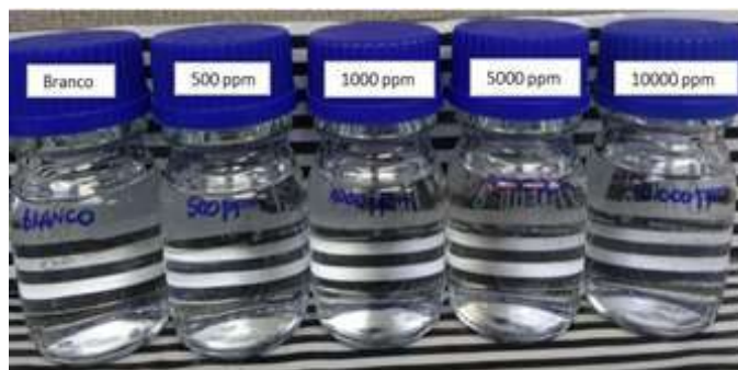
Figura 4.17 - Compatibilidade entre o Fosfonatø1 e a salmoura de TR-03 imediatamente após a adição do inibidor.
