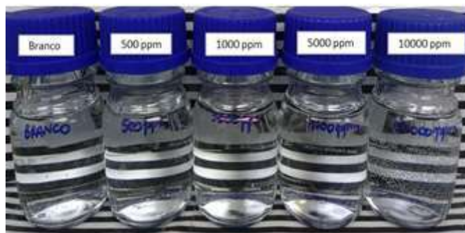
Figura 4.18 - Compatibilidade entre o Fosfonatø1 e a salmoura de TR-03 após 1h a 90°C.
