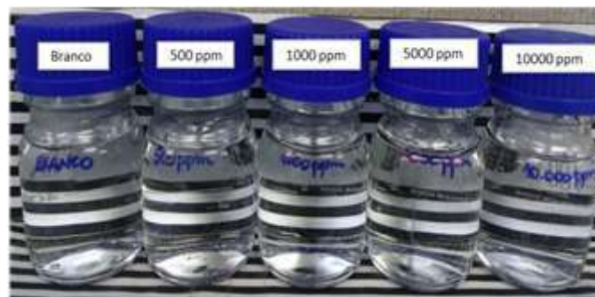
Figura 4.20 - Compatibilidade entre o Fosfonatø1 e a salmoura de TR-03 após 24h a 90°C.
