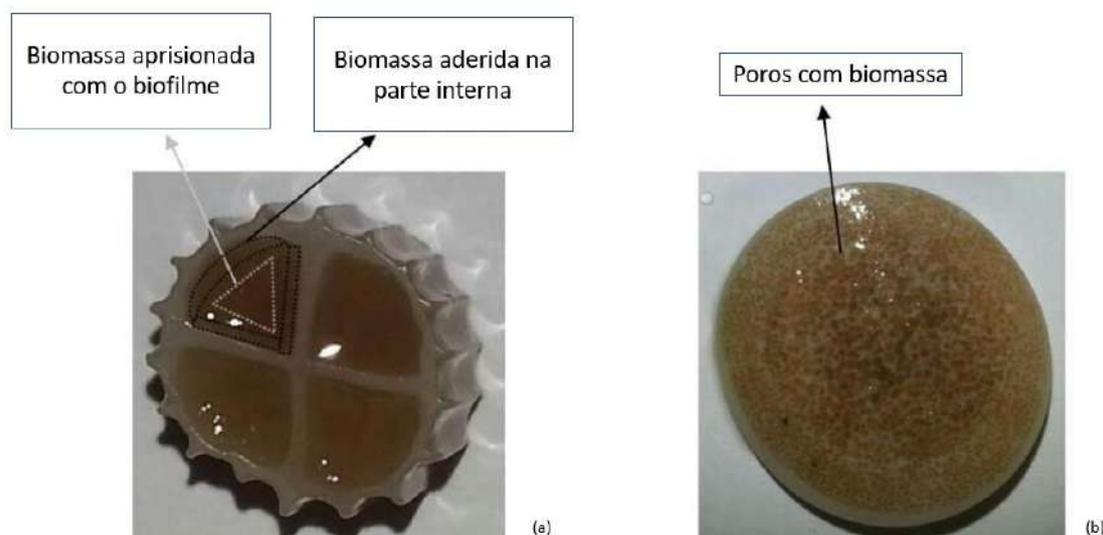
Figura 8: Diferentes tipos de Biomédias para MBBR, *AnoxKaldnes K1* (a) e *Mutag biochip* (b) (BASSIN, DIAS, et al., 2016)
