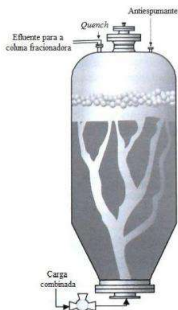
Figura 2.18 - Esquema de preenchimento da câmara de coqueamento.
