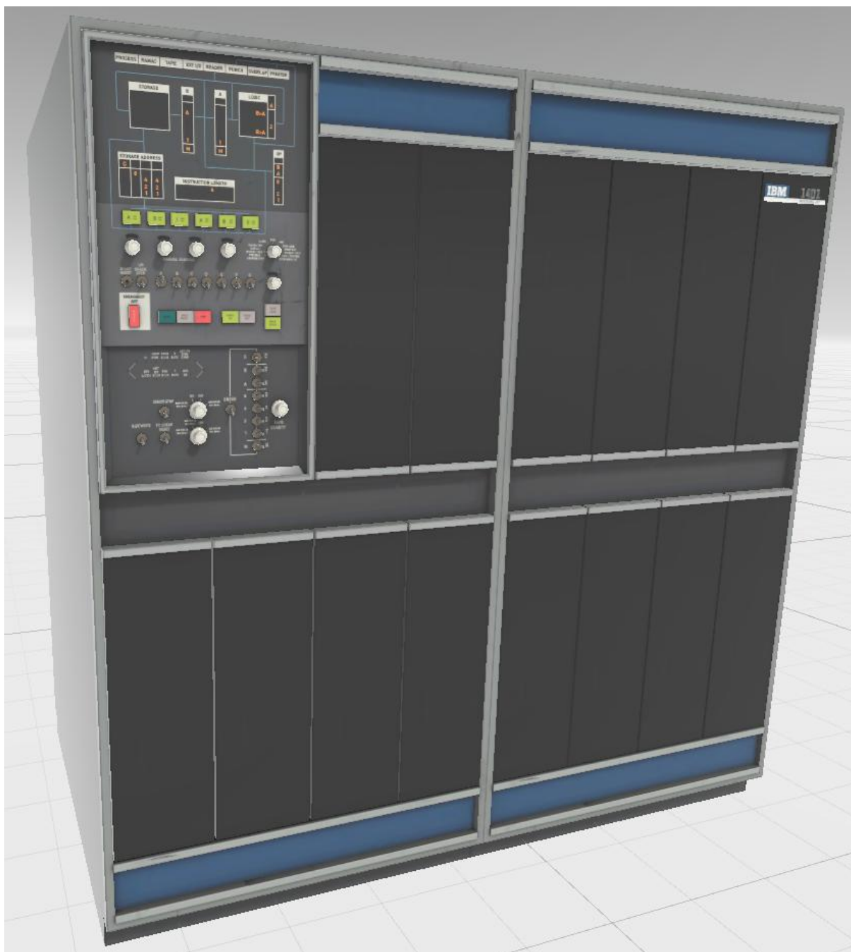
Figura 27: Unidade de processamento central 1401
