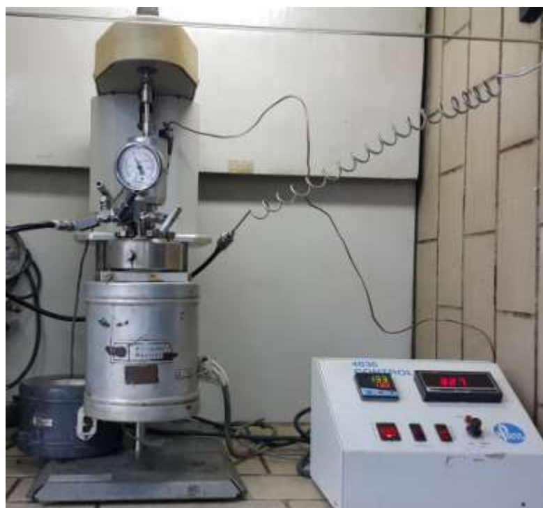
Figura 16. Reator Parr (0,5 L) Pressurizado
