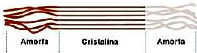
Figura 6: Esquemática das regiões cristalinas e amorfas da celulose
