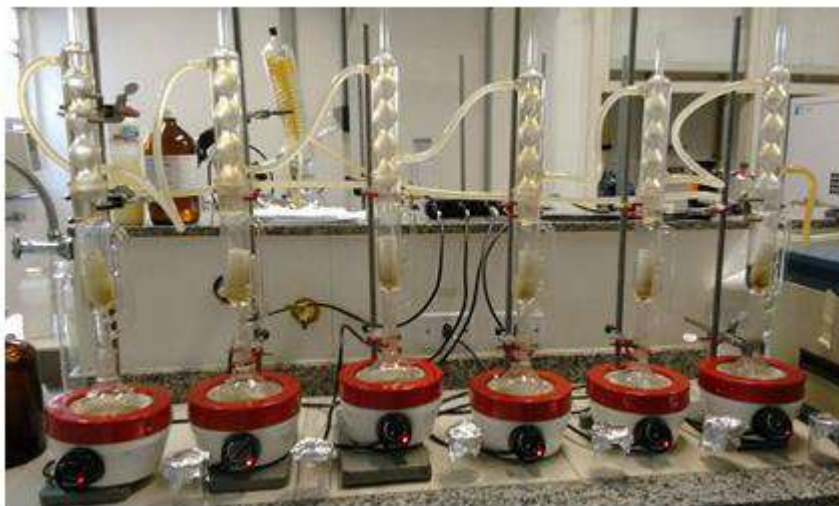
Figura 13: Esquemática do experimento de remoção de extrativos
