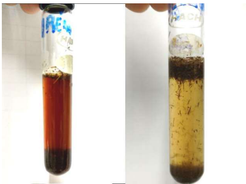
Figura 16: amostras dos solventes de ureia e de glicerol após o pré-tratamento e adição de solução 50% (v/v) acetona
