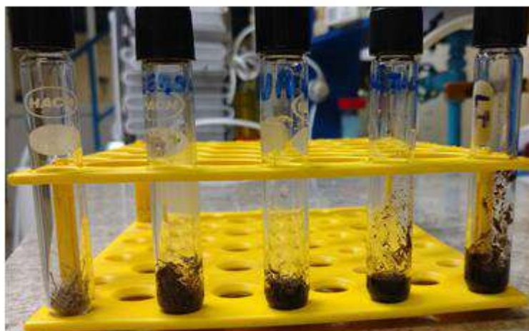
Figura 12: Experimentos do pré-tratamento em pequena escala para seleção do melhor Solvente Eutético
