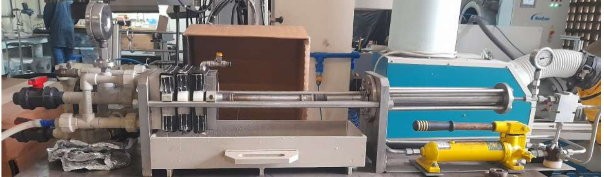
Figura 7: Filtro -prensa utilizado nos experimentos. Fonte: Própria autora.
