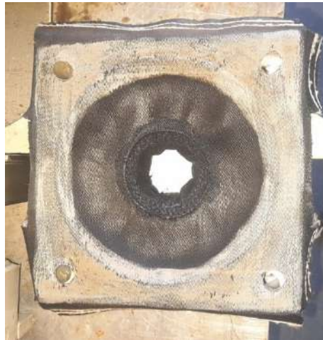
Figura 8: Placa utilizada no filtro-prensa. Fonte: Própria autora.
