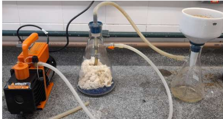
Figura 2: Aparelhagem para filtração a vácuo. Fonte: Própria autora
