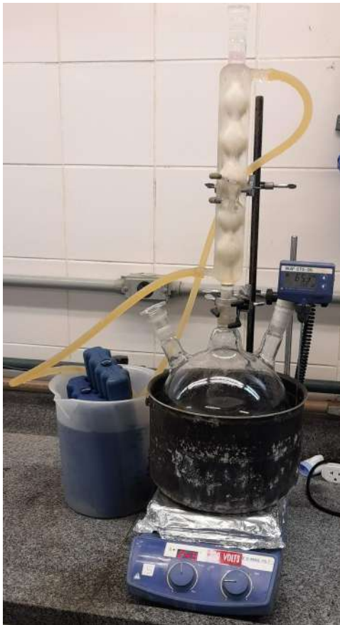
Figura 4: Aparelhagem para reação de lignina com ureia. Fonte: Própria autora.
