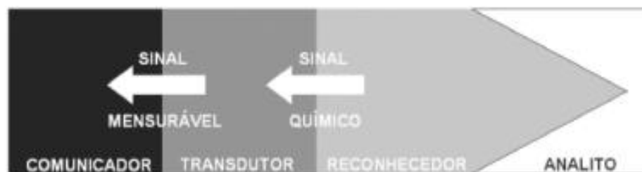
Figura 2 - Esquema geral dos principais componentes de um sensor químico.
