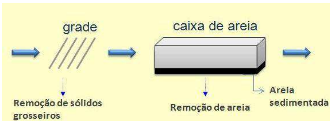
Figura 12 - Grades e caixa de areia no tratamento preliminar
