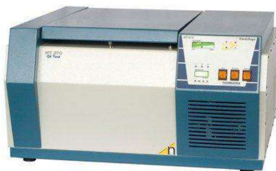
Figura 20 – Centrífuga para análise de BSW
