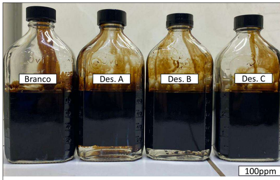
Figura 27 – Garrafas com o óleo O1 após decantação da água por efeito dos desemulsificantes no tempo de 15 minutos na dosagem de 100ppm.
