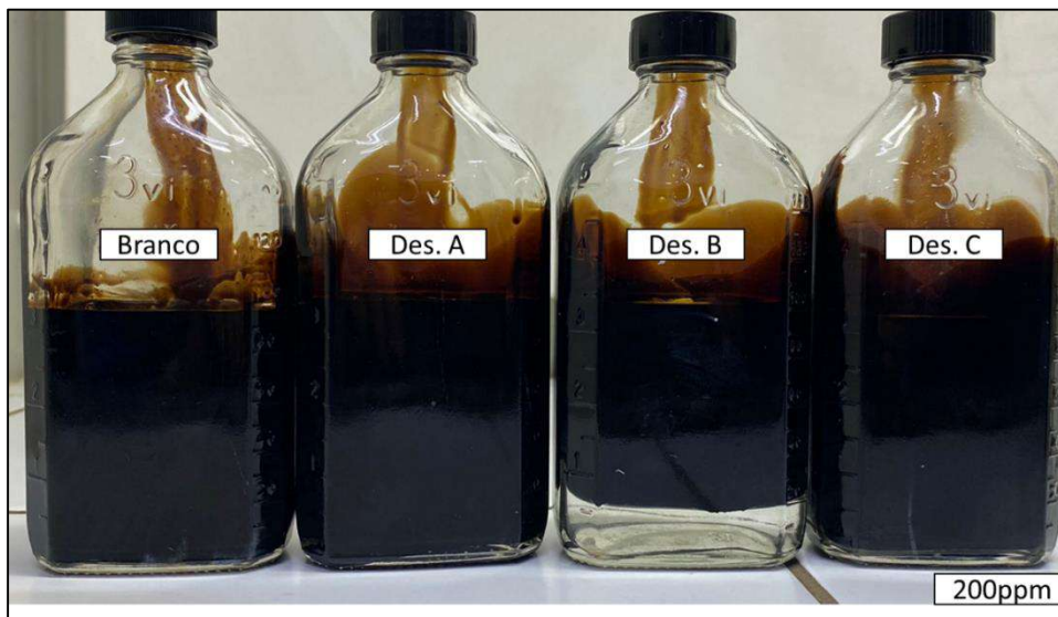
Figura 32 – Garrafas com o óleo O2 após decantação da água por efeito dos desemulsificantes no tempo de 15 minutos na dosagem de 200ppm.
