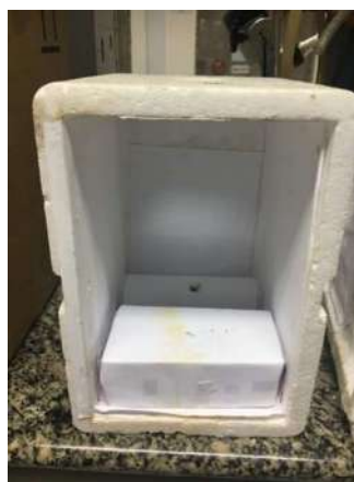
Figura 13b. Imagem da câmara fotográfica com iluminação controlada a base de LEDs de alta potência, empregada para a aquisição das imagens digitais.
