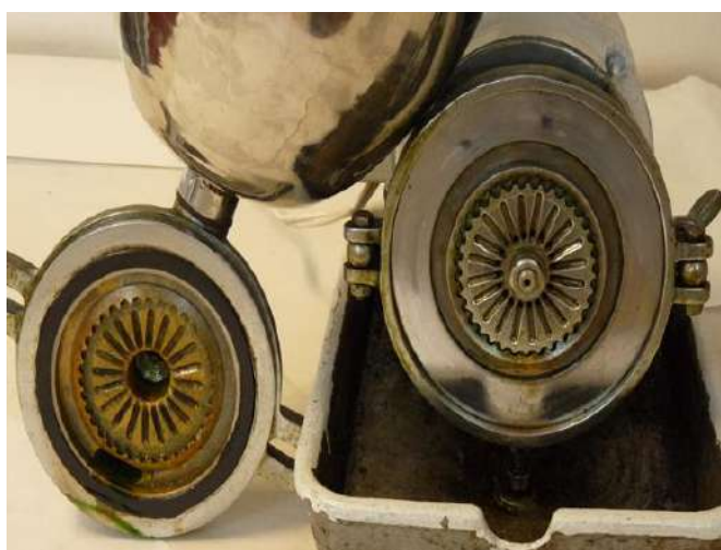
Figura 3.1 – Interior de Moinho Coloidal, mostrando rotor e estator
