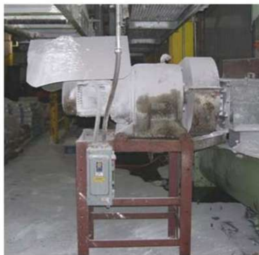
Figura 18: Camadas de açúcar acumuladas em pisos e equipamentos da Imperial Sugar. (CSB, 2009)
