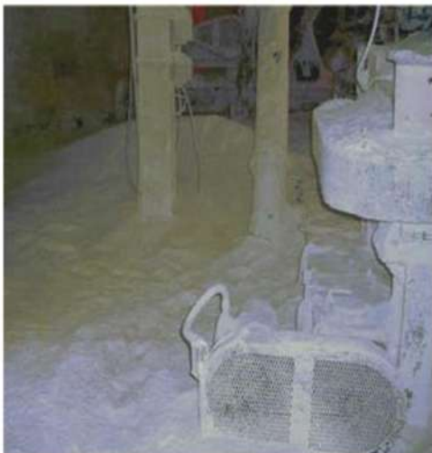
Figura 18: Camadas de açúcar acumuladas em pisos e equipamentos da Imperial Sugar. (CSB, 2009)
