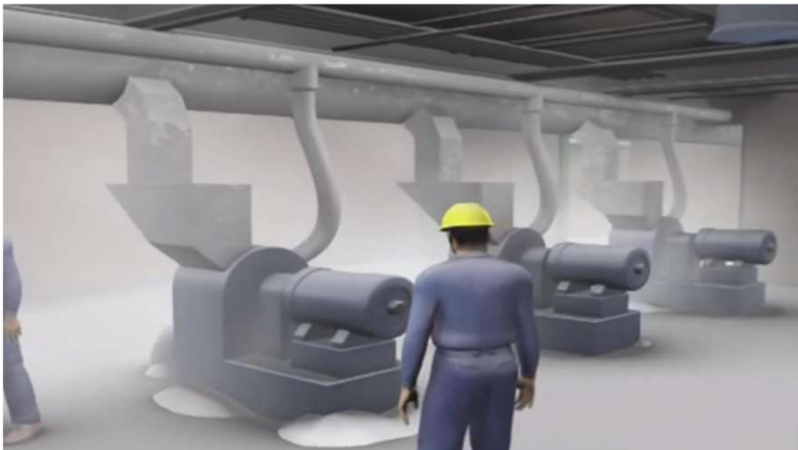
Figura 22: Demais áreas da fábrica, com também acúmulo de pó em suspensão (CSB, 2009)
