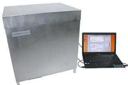
Figura 31. Calorímetro isotérmico com monitoramento computacional.
