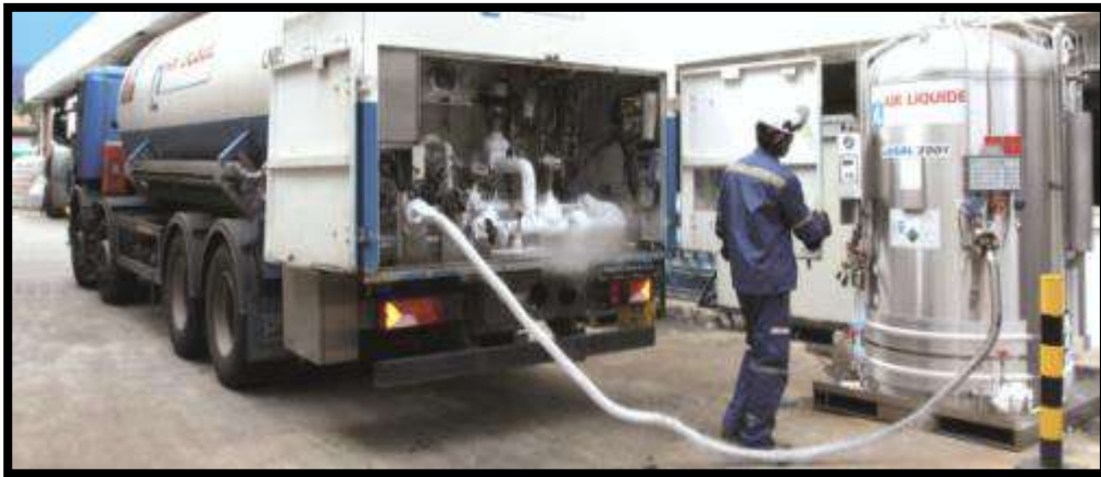
Figura 23 – Fornecimento do tipo granel a um tanque microbulk . Fonte: Air Liquide, 2017b.
