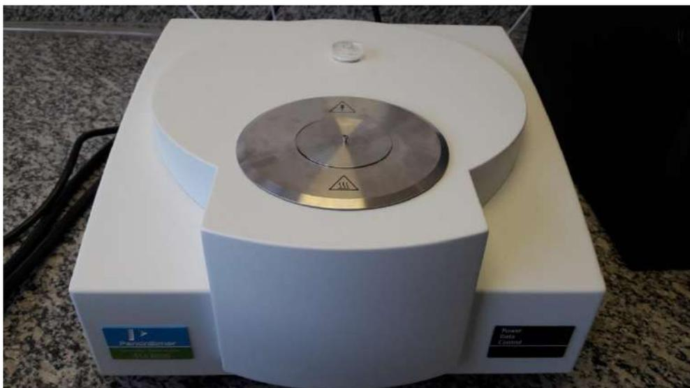
Figura 7. Equipamento de análise termogravimétrica (TGA) da marca Perkin Elmer e modelo STA 6000.
