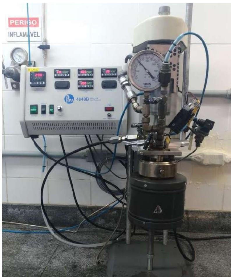
Figura 8. Reator fechado no qual foram conduzidas as reações de hidrólise parcial do óleo de soja, com seus devidos componentes.
