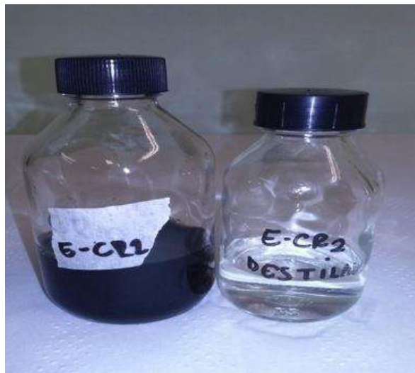
Figura 3.24: Etanol gerado por destilação a partir do caldo fermentado proveniente da fermentação dos hidrolisados. Fonte: Laboratório GreenTec (2016).
