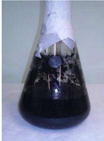
Figura 3.20: Torta residual submetida ao tratamento térmico embebido em uma solução básica. Fonte: Laboratório GreenTec (2016).
