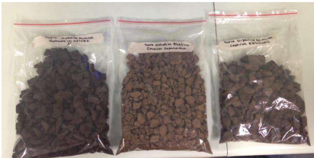
Figura 3.22: Celulose resultante da hidrólise alcalina realizada na torta residual proveniente da hidrólise ácida da hemicelulose originária das amostras GR01, CD01 e CR01, respectivamente. Fonte: Laboratório GreenTec (2016).
