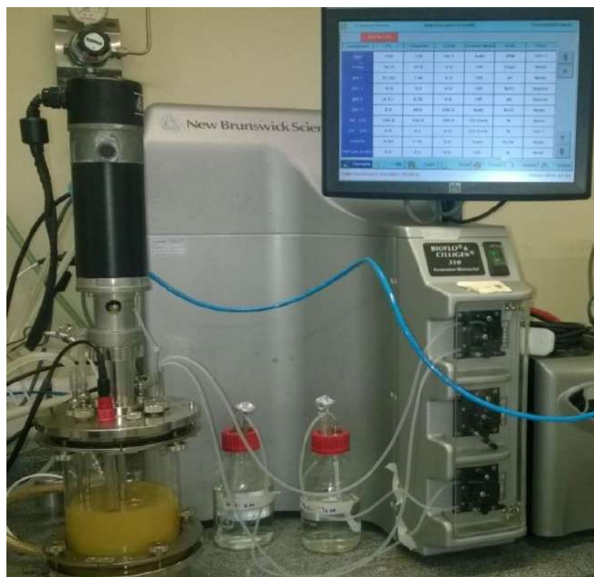
Figura 3.23: Biorreator New Brunswick BioFlo 310 ® utilizado para a fermentação dos hidrolisados. Fonte: LADEBIO (2017).
