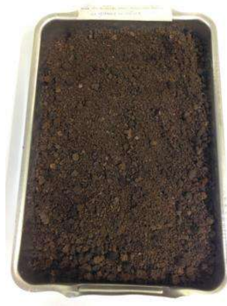
Figura 3.17: Torta residual proveniente da hidrólise da hemicelulose contida na galhada residual (G R 01). Laboratório GreenTec (2016).
