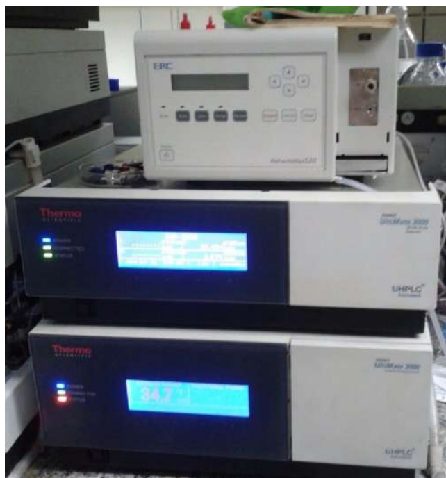
Figura 11: Equipamento de Cromatografia Líquida de Alta Eficiência (CLAE), da marca Dionex, modelo UltiMate 3000.
