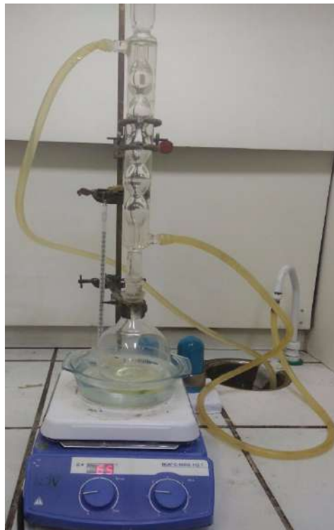
Figura 6: Produção de biodiesel via catálise alcalina homogênea.
