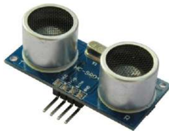
Figura 3-14: Sensor ultrassônico HC-SR04.
