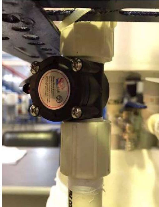
Figura 3-17: Sensor de fluxo acoplado à tubulação.
