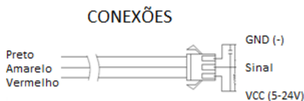
Figura 3-13: Detalhe da conexão do sensor YF-S201 [14].
