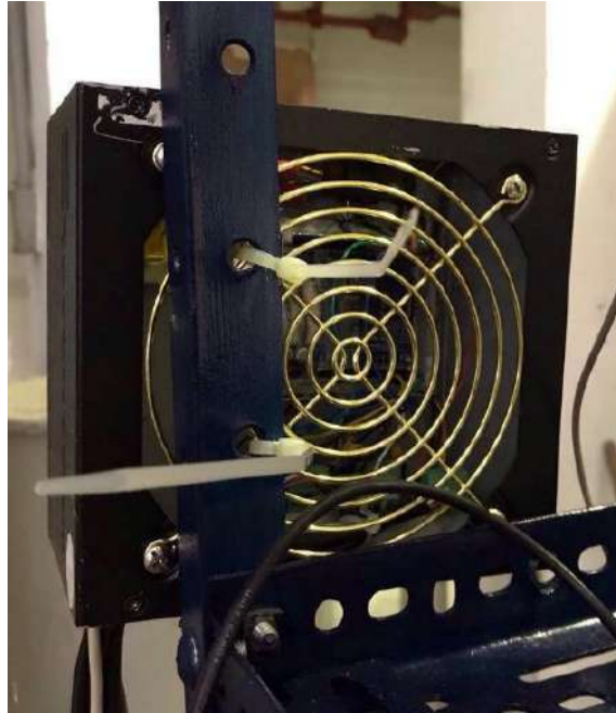
Figura 3-5: caixa metálica usada para proteger o Arduino.
