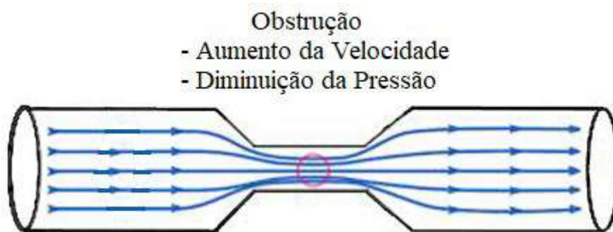
Figura 2-2: Efeitos causados pela obstrução do fluxo, demonstrados num Tubo de Vari [4].
