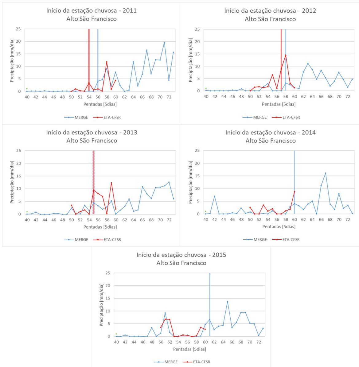
Figura 4.18 - Definição do início da estação chuvosa para o Alto São Francisco usando métodos de pântadas (5 dias) baseados na precipitação para os anos 2011 a 2015. Linhas azul e vermelha representam médias de cinco dias precipitação (mm/dia), para o MERGE e o Eta-CFSR, respectivamente. As barras verticais indicam a pântada característica do início da estação chuvosa para MERGE, azul, e para Eta-CFSR, vermelho.
