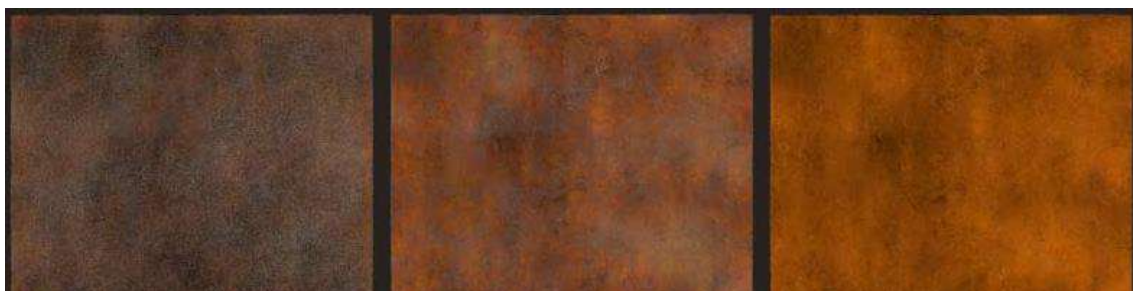
Figura 2: Superfícies com diferentes intensidades de flash rust , com flash rust leve, moderado e intenso da esquerda para a direita ( blastjournal , 2017).
