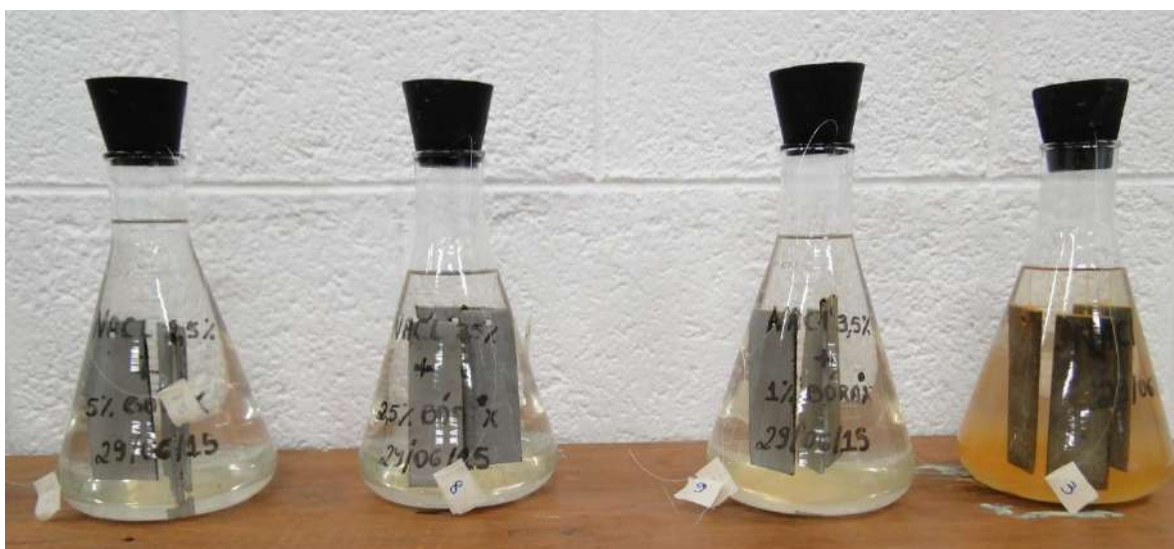
Figura 10: Corpos de prova submersos em solução salina para ensaio de perda de massa.
