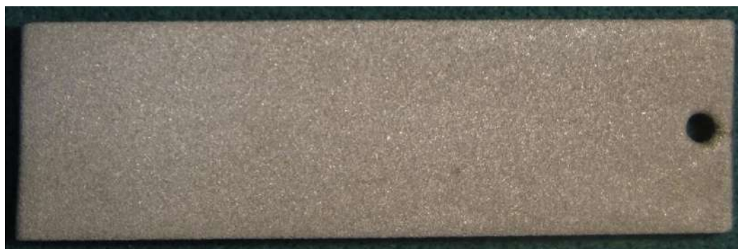
Figura 9: Corpo de prova com grau de limpeza Sa 3 após jateamento abrasivo seco.
