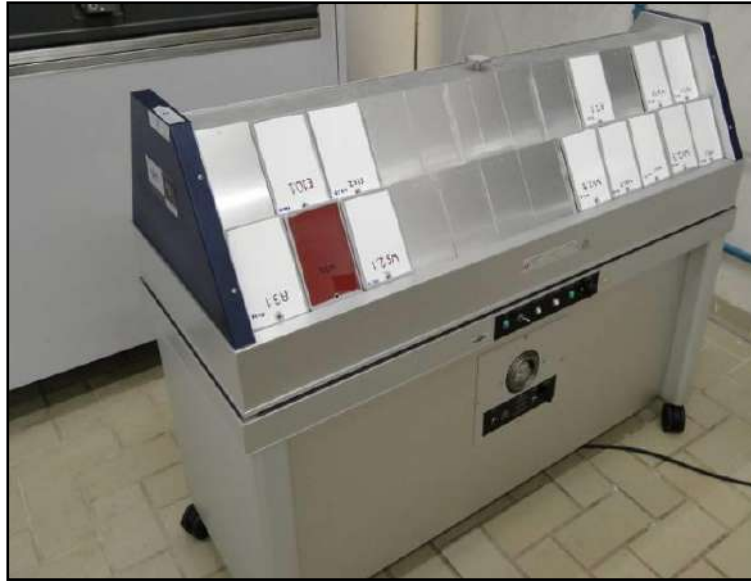
Figura 11: Câmara de condensação de umidade, com os corpos de prova revestidos
