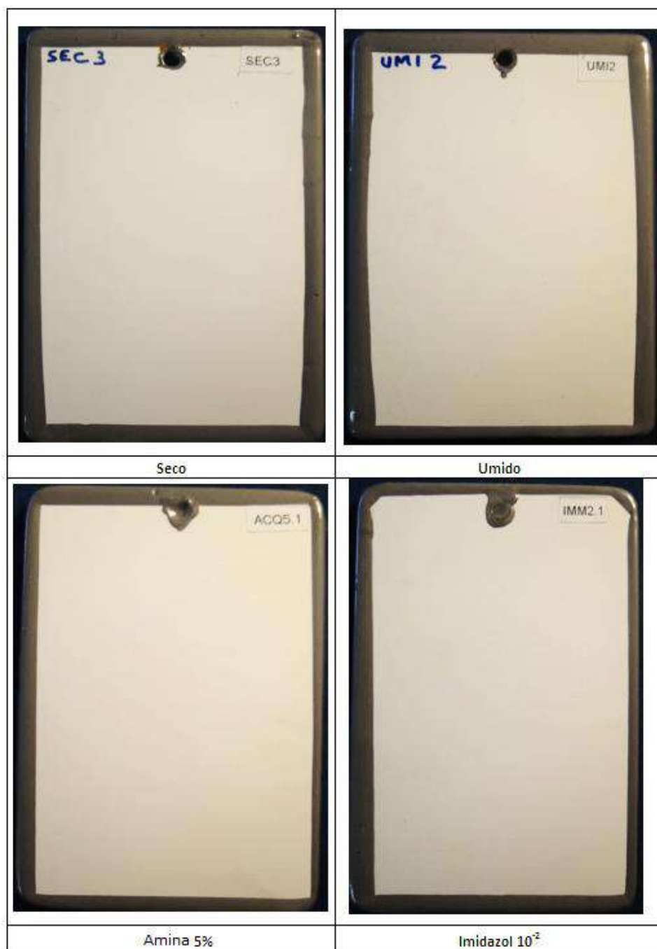
Figura 24: Corpos de Prova após 720h de ensaio em câmara de condensação de umidade
