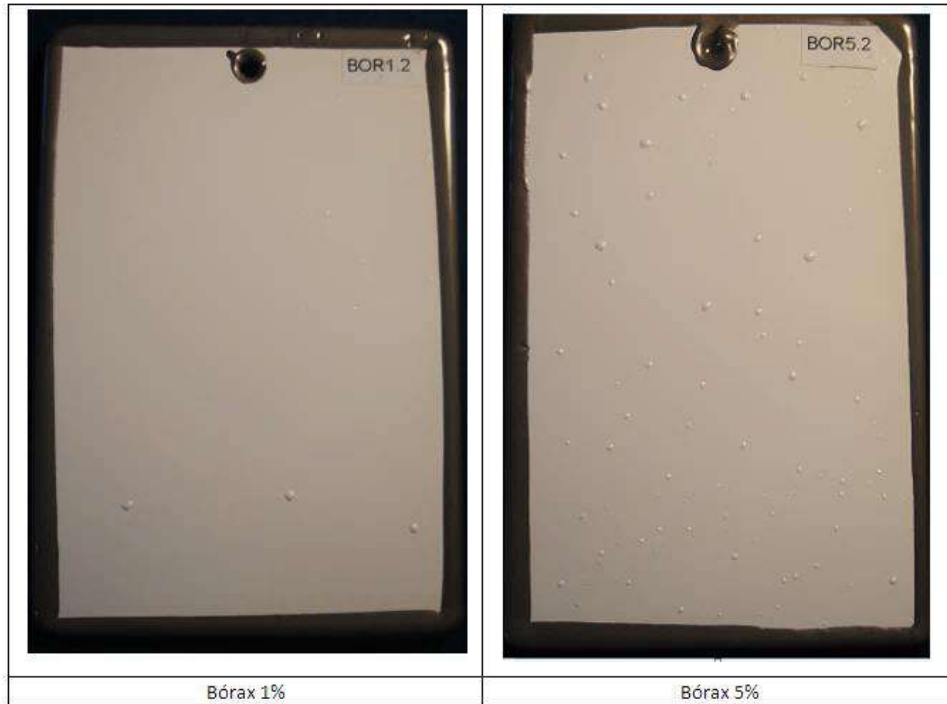
Figura 22: Corpos de Prova com aplicação de solução bórax após 24h de ensaio em câmara de condensação de umidade
