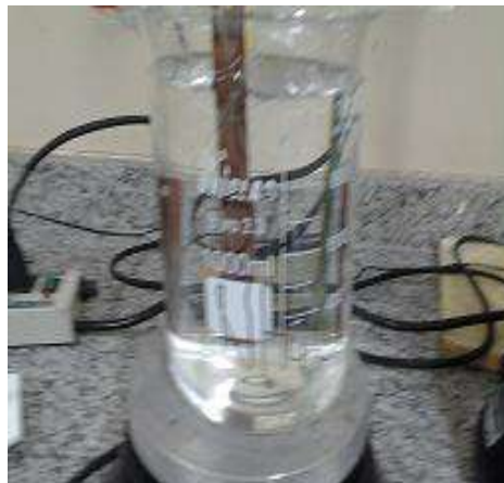
Figura 23: Corpos de prova de cobre imersos num bechere contendo água destilada sendo aquecido a 30 °C, 24 horas depois.
