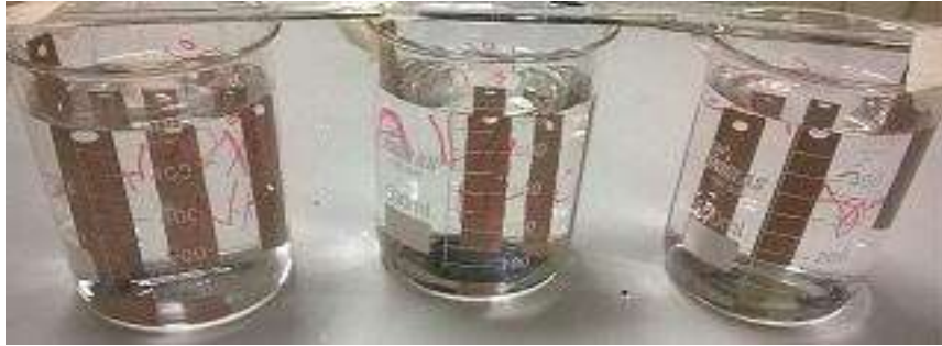
FIGURA 22: Corpos de prova de cobre imersos em concentrações de soluções de 10%, 1% e 0% de cloreto de amônio (m/v) logo antes de serem aquecidos à 30\pm 32 °C.
