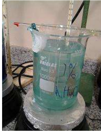
Figura 24: Corpos de prova de cobre imersos num bechere contendo 1% de concentração de cloreto de amônio (m/v) sendo aquecido a 30 °C, 24 horas depois.
