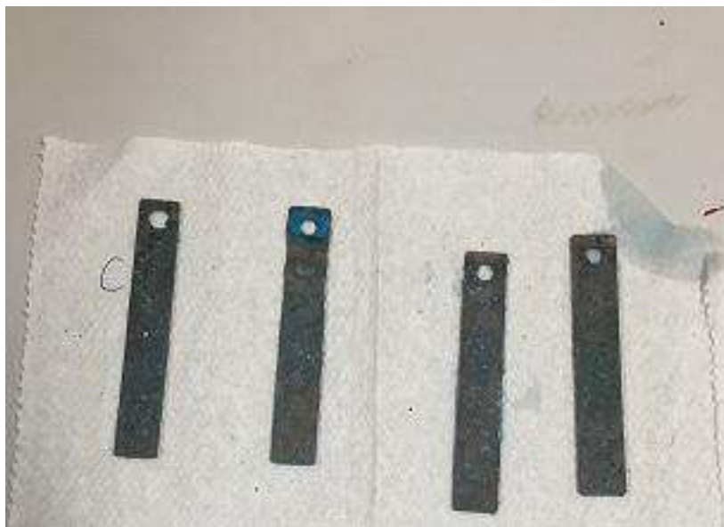
FIGURA 20: Corpos de prova de cobre que foram imersos em 10% de concentração de solução de \text{NH}_4\text{Cl} (m/v) à temperatura ambiente durante 14 dias, logo após a sua retirada.
