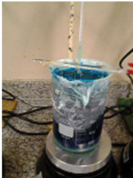
Figura 25: Corpos de prova de cobre imersos num bechere contendo 10% de concentração de cloreto de amônio (m/v) sendo aquecido a 30 °C, 24 horas depois.
