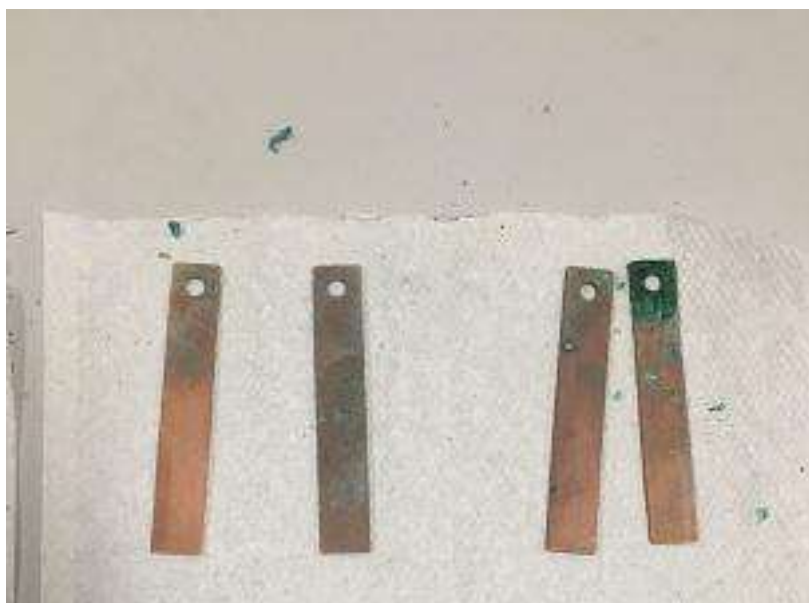
FIGURA 19: Corpos de prova de cobre que foram imersos em 1% de concentração de solução de \text{NH}_4\text{Cl} (m/v) à temperatura ambiente durante 14 dias, logo após a sua retirada.
