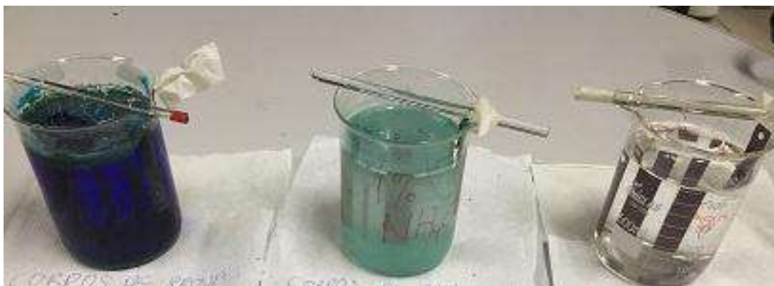
FIGURA 17: Placas, (ou corpo de prova) de cobre imersos em 10%, 1% e 0% (água destilado) respectivamente de concentrações de solução de \text{NH}_4\text{Cl} (m/v) à temperatura ambiente após 14 dias. A mudança de cor ocorreu após 24 horas.
