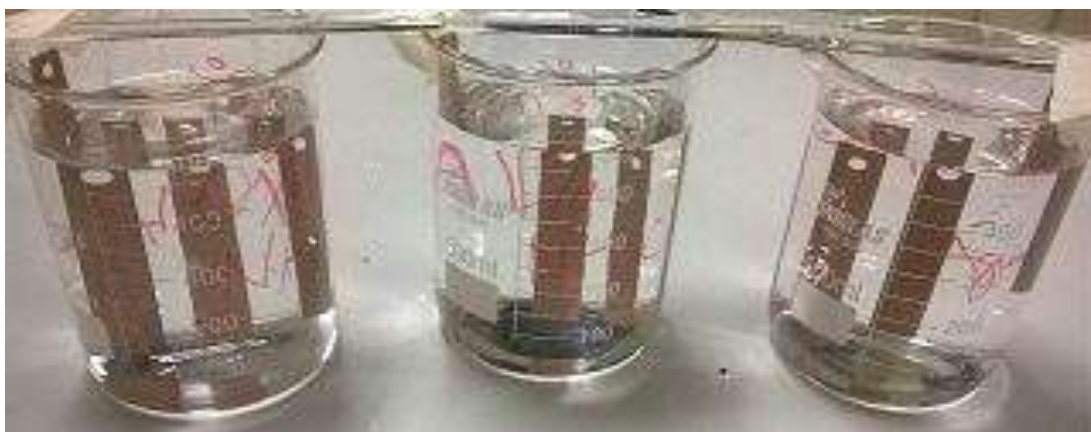
FIGURA 16: Placas de cobre imersos em 10%, 1% e 0% respectivamente de concentrações de cloreto de amônio ( \text{NH}_4\text{Cl} ) (m/v) no início do experimento no dia 1 do experimento à temperatura ambiente.
