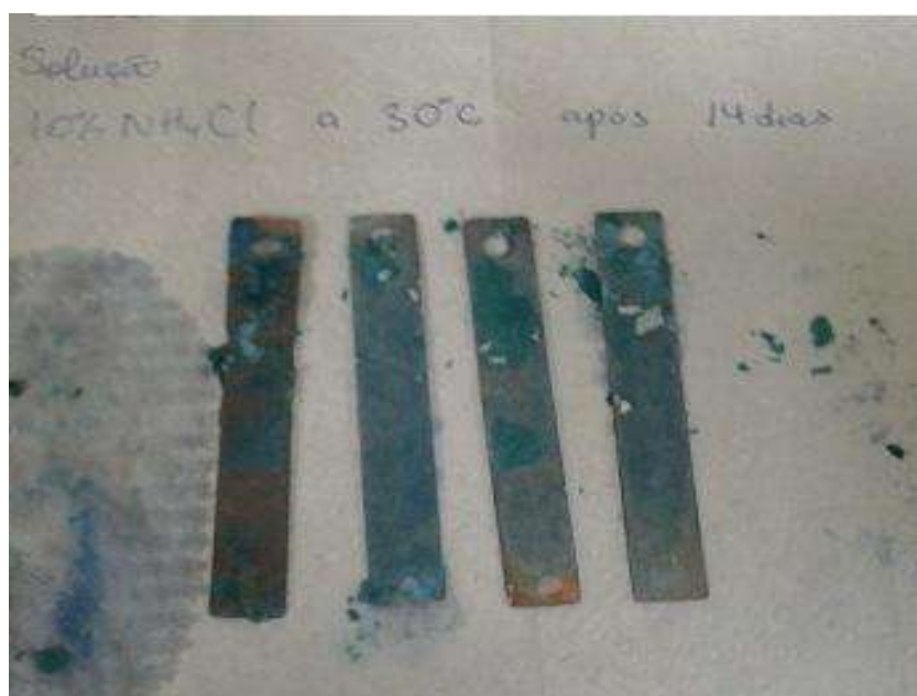
Figura 28: Acima são os corpos de prova de cobre imersos em 10% concentração de cloreto de amônio (m/v) durante 14 dias à temperatura de 30\pm 32^\circ\text{C} , após a sua retirada.
