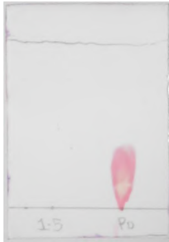
Figura 29: Cromatografia da subfração 1-5 coletada na Sephadex, revelada com ninhidrina. O sistema de eluentes foi BAW (3: 1: 1).
