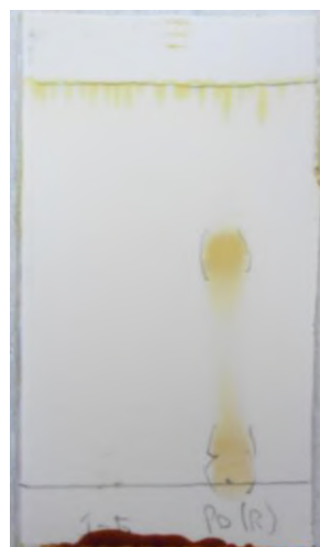
Figura 30: CCD revelada com vapor de iodo. O sistema de eluentes foi BAW (3: 1: 1).
