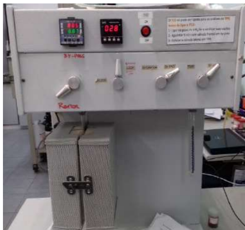
Figura 3.2: Equipamento usado para as análises de TPR e TPD (Acervo próprio).
