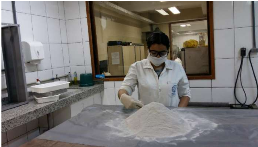
Figura 4.5 – Ilustração do quartear amostra realizado (Fonte: Própria autora, 2017)
