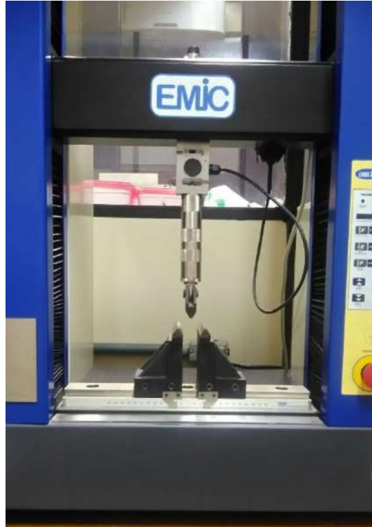
Figura 4.11 – Equipamento para ensaio de tensão de ruptura à flexão (Fonte: Própria autora, 2017)
