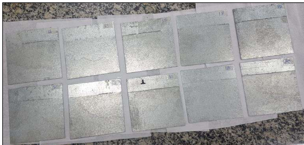
Figura 21 - Sucatas após a lixiviação com hidróxido de sódio
