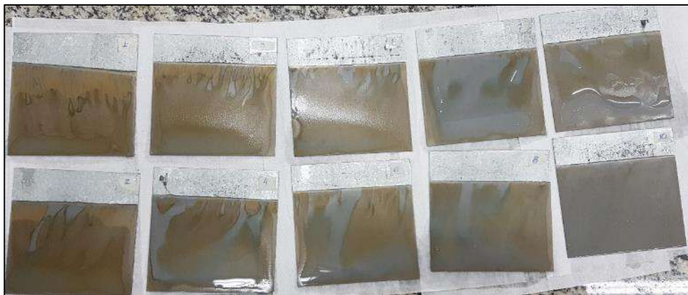
Figura 20 - Sucatas após a lixiviação com ácido sulfúrico
