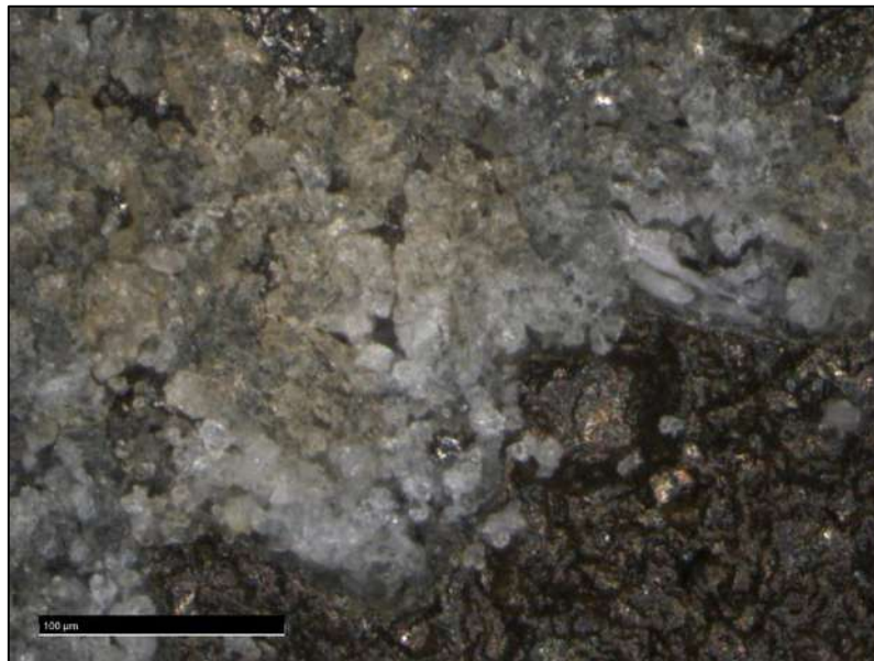
Figura 41 – Microscopia óptica do eletrodepositado a partir de solução ácida e densidade de corrente de 10 A/dm 2 com aumento de 1000x.
