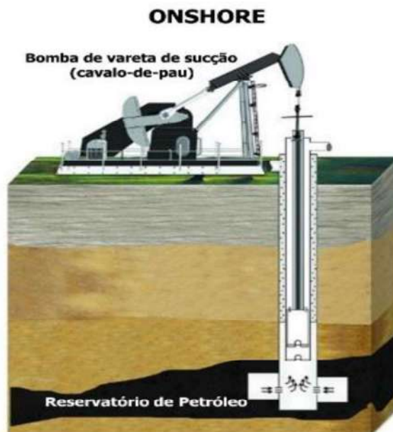
Figura 3 - Bomba de sucção para produção de petróleo onshore.
