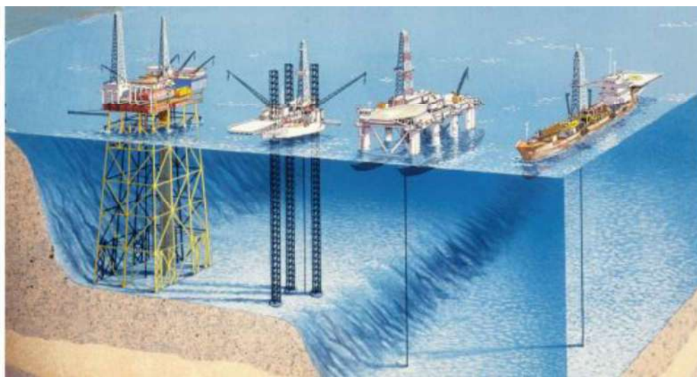
Figura 4 - Plataformas: fixa, autoelevatória, semissubmersível e navio de produção e estocagem (FPSO).
