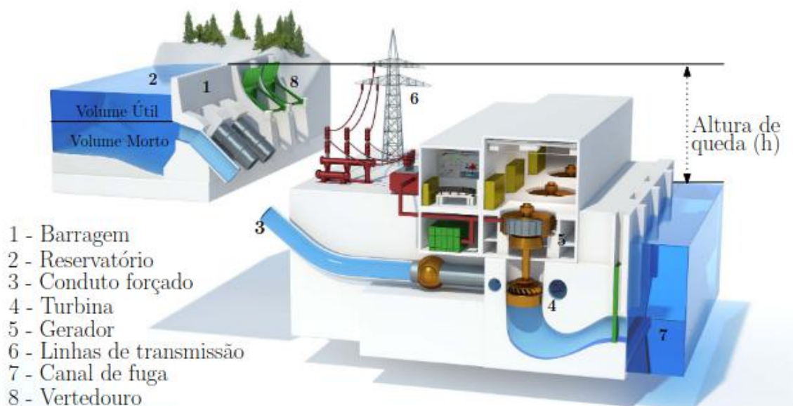
Figura 5 – Principais componentes de uma UHE
