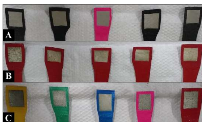
Figura 38 - Aspecto dos corpos de prova após o término do experimento do Lote IV das células: A) Intactos; B) Controle e C) Lixados.
