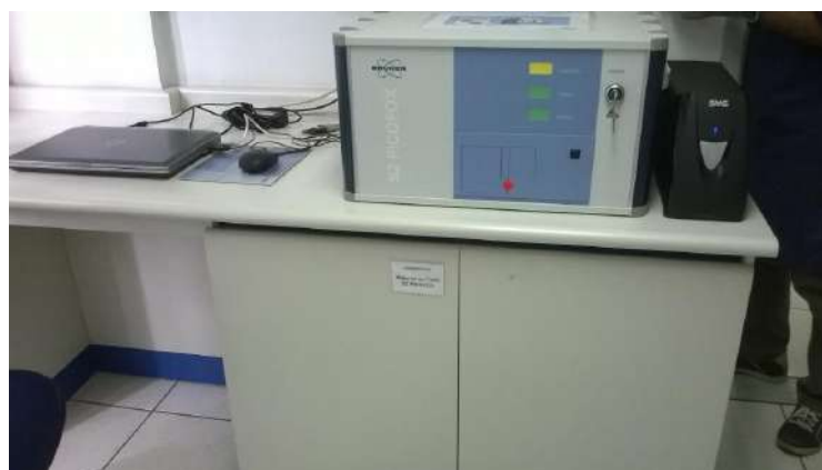
Figura 17 – Equipamento de TXRF s2 PICOFOX do Instituto Nacional de Tecnologia
