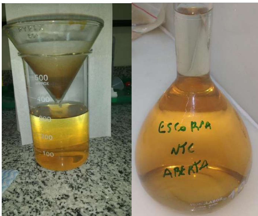
Figura 7 – Resíduo NTC totalmente aberto após a lixiviação ácida
