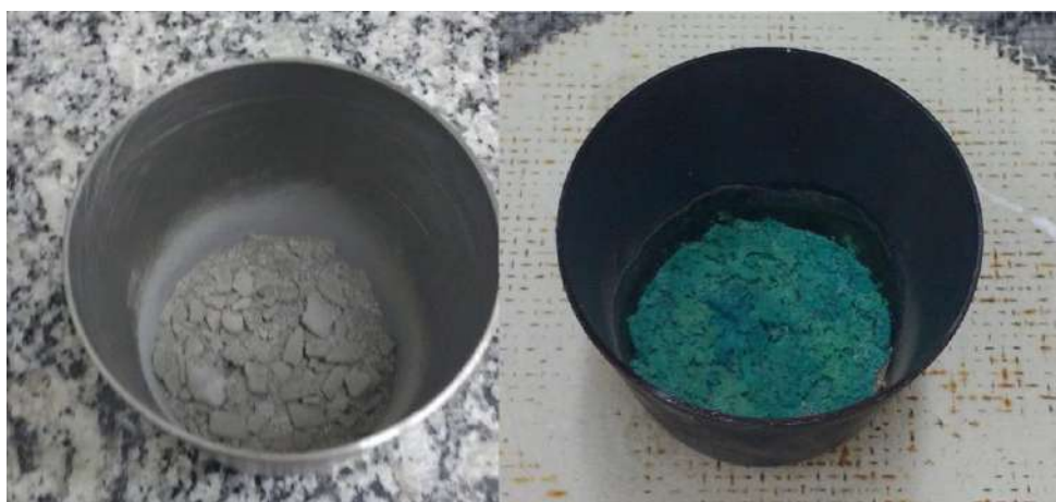
Figura 5- Mistura resíduo + NaOH pré e pós fusão alcalina
