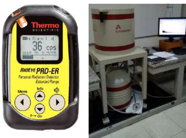
Figura 14 – Medidor de atividade Thermo scientific e Espectrômetro acoplado com detector HPGc GC 3020, marca Camberra
