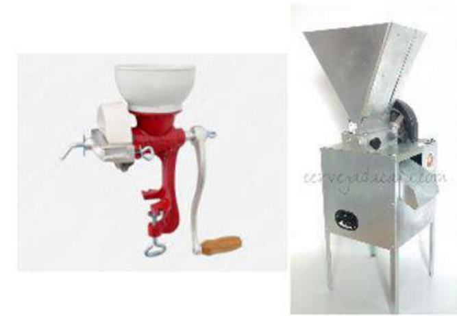
Figura 4 - Moinho de disco manual (à esquerda) e moinho de rolo automático (à direita). Fonte: Cerveja de Casa, 2017.
