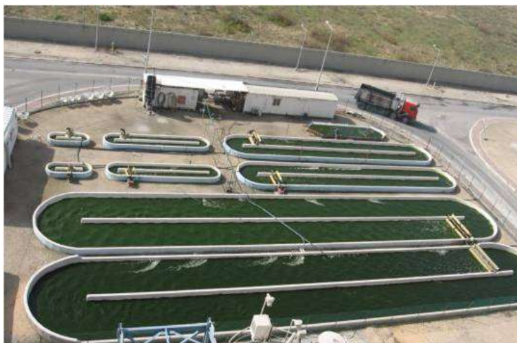
Figura III.6 - Sistema raceway, tanques de forma a permitir uma boa iluminação em toda sua extensão e presença de um agitador que faz com que a água percorra um circuito.
