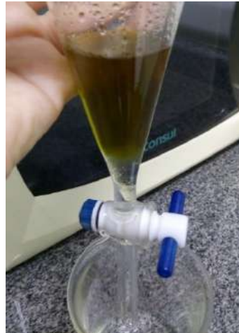
Figura IV.5 - Lavagem fase etérea com água deionizada para remoção do HCl.
