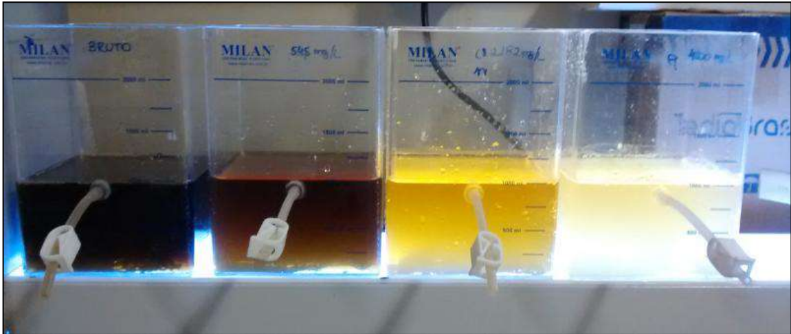
Figura 32. Comparação entre o lixiviado bruto e lixiviado após pré-tratamento.
