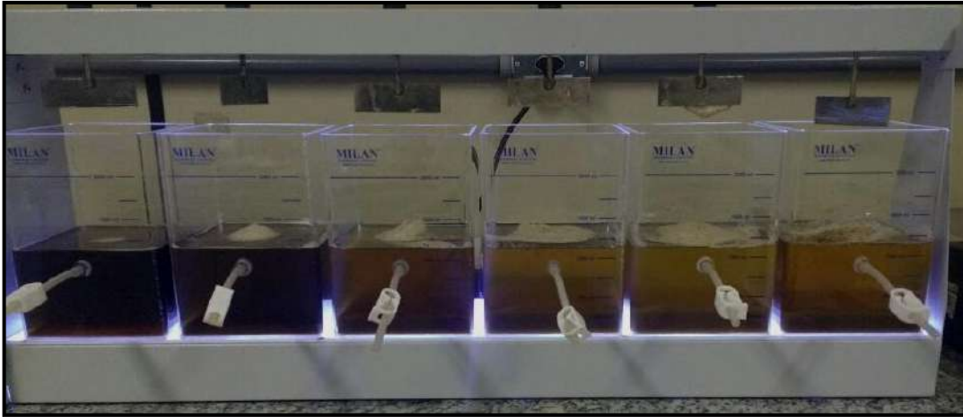
Figura 25. Etapa 1 da coagulação-floculação com o \text{Al}_2(\text{SO}_4)_3 .
