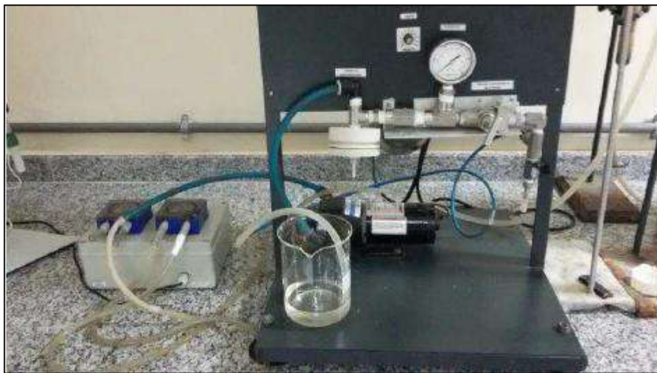
Figura 13. Sistema pressurizado para avaliação de SDI e MFI
