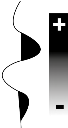
Figura 19 - Representação do padrão SEG normal para a polaridade da wiggle.
