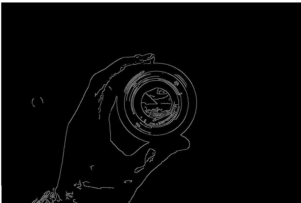
Figura 14 – Imagem após filtro Hysteresis Thresholding e com multiplicação das intensidades por 50 realizada
