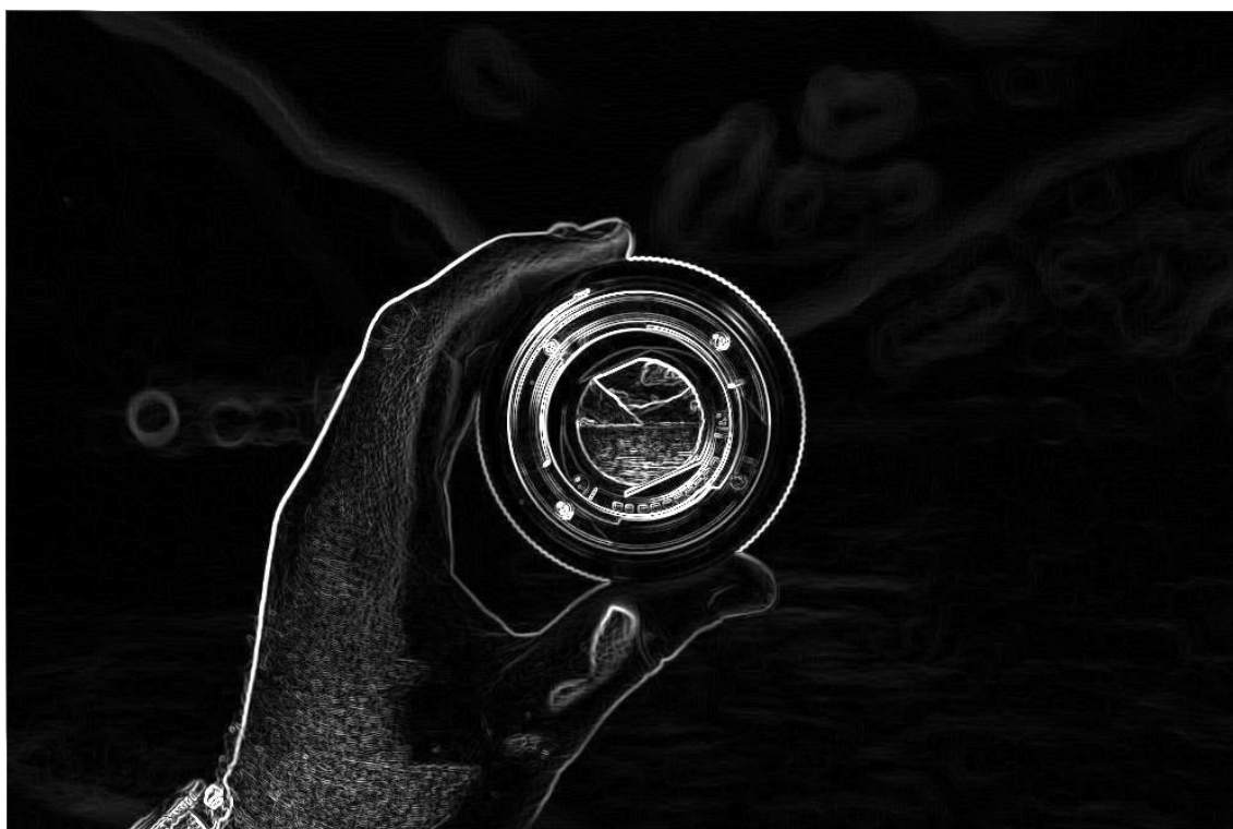
Figura 6 – Imagem obtida através de magnitudes das coordenadas polares dos vetores de intensidade
