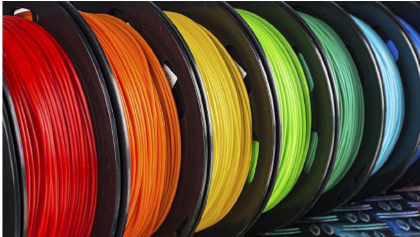
Figura 48 – Filamentos de PLA para impressão 3d. Fonte: https://www.impresoras3d.com/pt/filamento-pla-dicas-caracter%C3%ADsticas-e-muito-mais/
