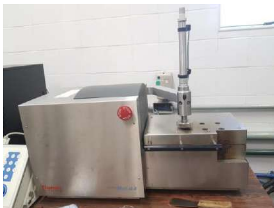
Figura 7. Imagem da Mini-Extrusora Haake modelo Minilab II.
