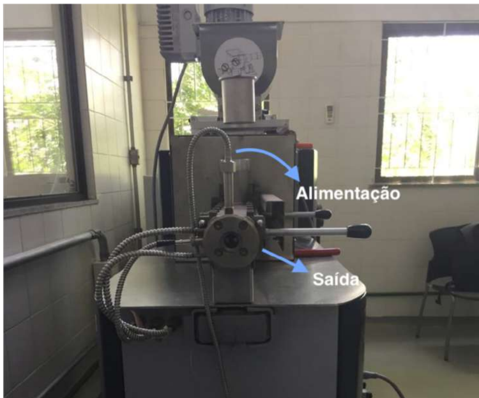
Figura 4.3 – Zonas de Alimentação, Aquecimento e Saída da Extrusora de Rosca Dupla (Vista Frontal)
