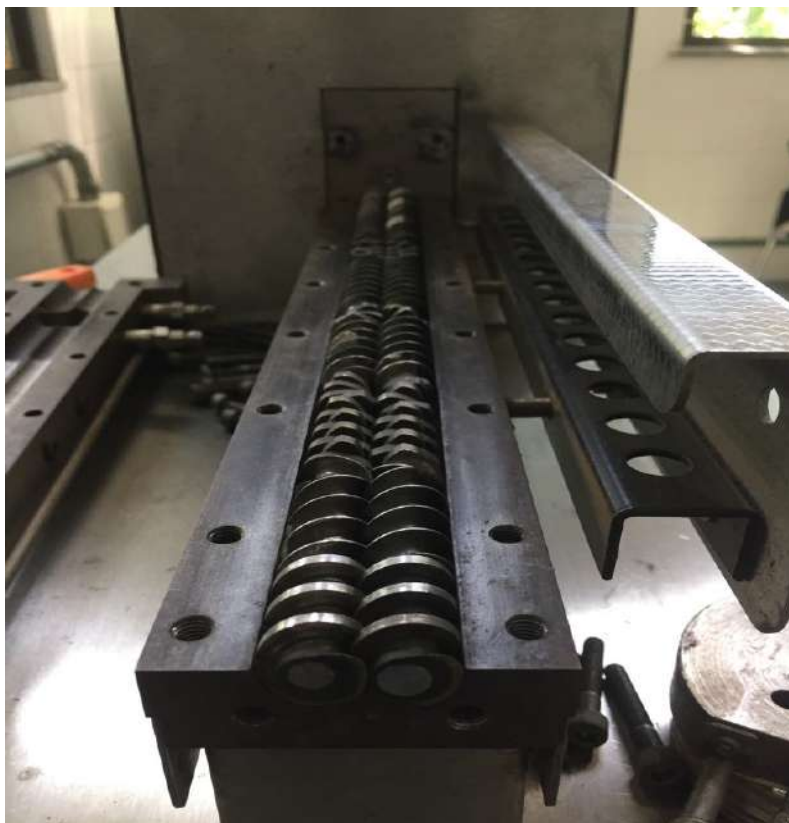
Figura 4.4 – Configuração da rosca dupla utilizada neste estudo
