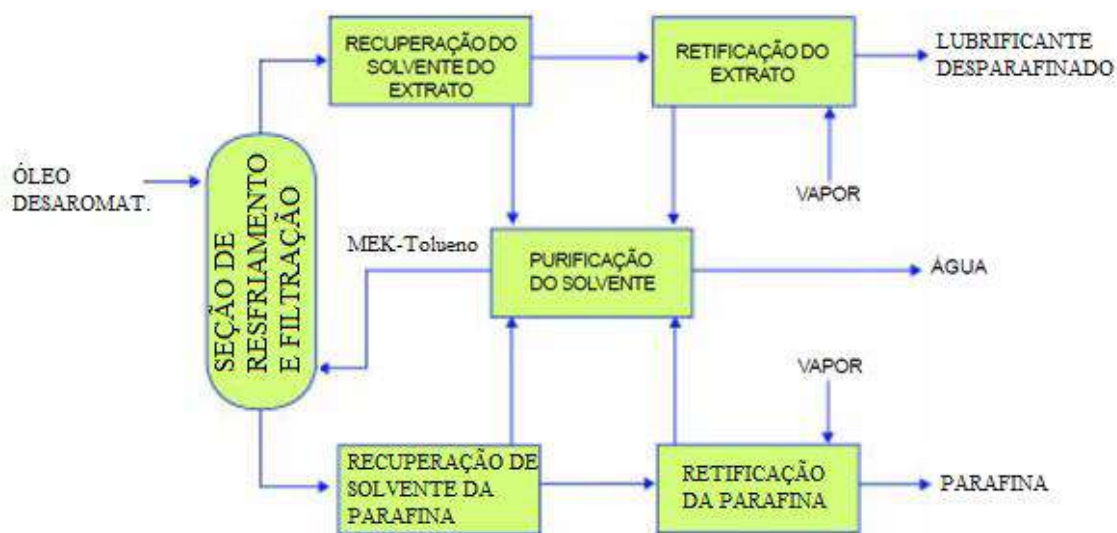
Figura 4: Diagrama simplificado de desparafinação à solvente. Fonte: Adaptado de PETROBRAS, 2012.
