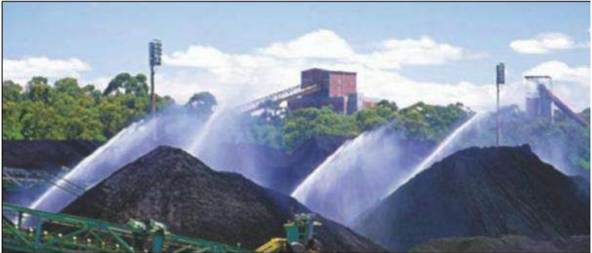
Figura 2.5 - Aspersão de água em pátio de matéria-prima (ARCELORMITTAL TUBARÃO 2016)
