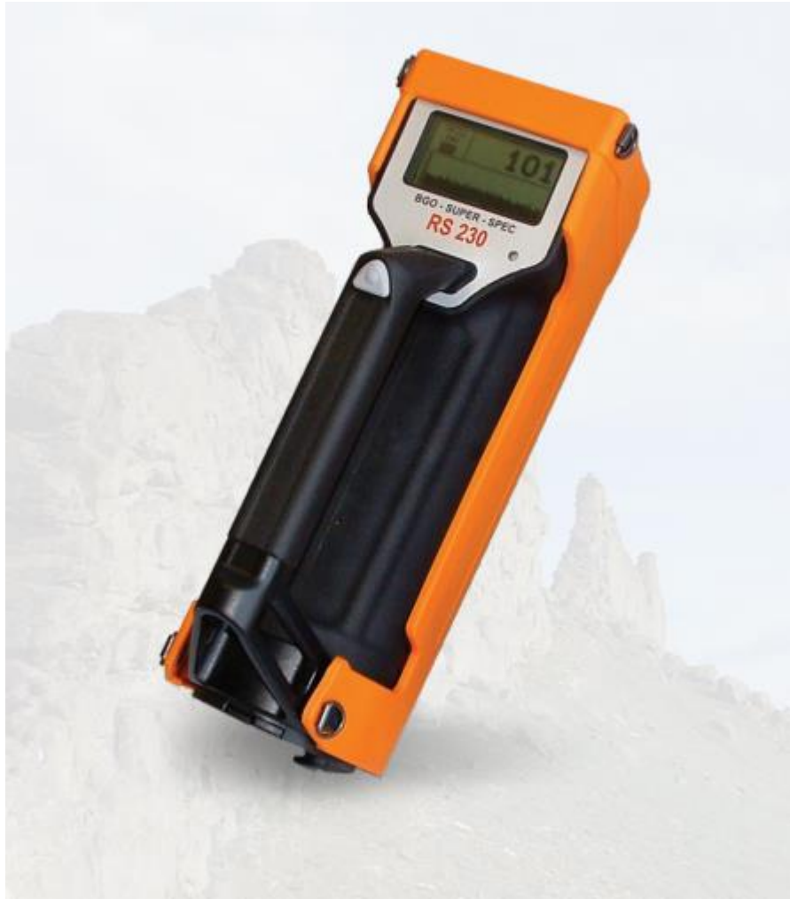
Figura 7: Fotografia do gamaespectrômetro portátil (Radiations Solutions Inc., modelo RS-230 BGO Super-SPEC) utilizado para a aquisição dos dados analisados no presente estudo. Extraída do manual do aparelho.
